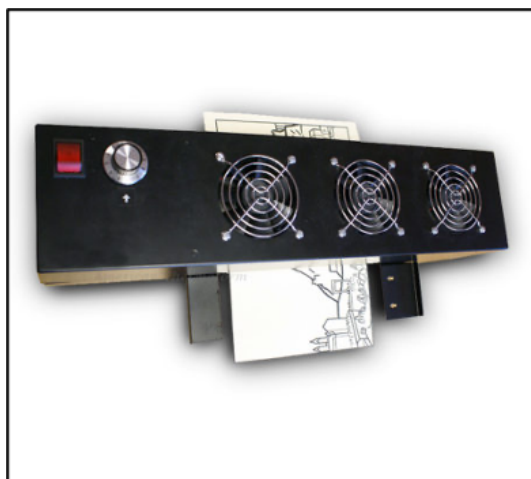
Figura 1: (1) Horno para papel de microcápsulas, modelo Zychem. Fuente: www.mondoausili.it (2) Fase de exposición del papel a la luz infrarroja. A contraluz, se pueden apreciar visualmente los relieves del dibujo.
